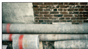
© INRS Canalisation en amiante ciment
