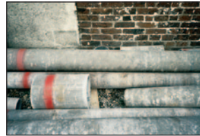
Crédits : INRS Canalisation en amiante ciment
